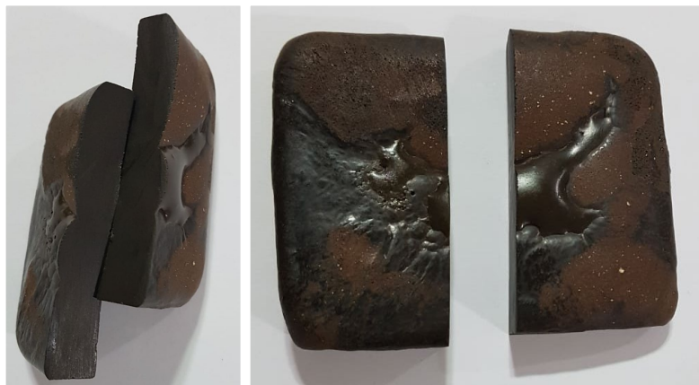
Figura 5. Peça vitro-cerâmica cristalizada a 850°C, obtida através de fusão do rejeito a 1.400°C e recozimento a 675°C.
